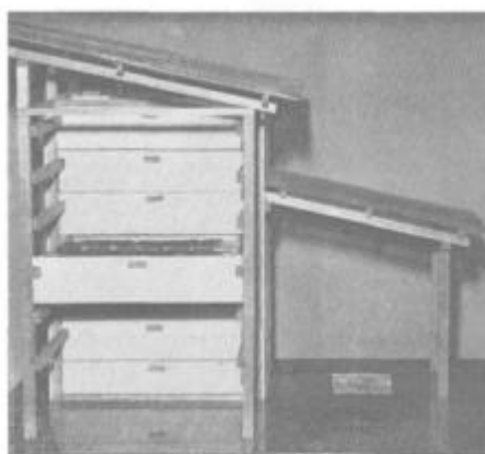
Gambar: "Atas: Bentuk baru rumah asap menyerupai bangunan rumah yang mempunyai dua baris lachi. Kiri: Rumah asap berbentuk almari."
